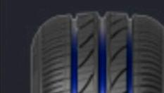
**Diseño de tres ranuras:** La especificación de ancho de sección 175 y menos, 185 (relación de ancho de altura 70 y superior).
