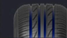
**Diseño de cuatro ranuras:** La especificación del ancho de la sección de 195 y más, 185 (relación de ancho de altura de 65 y menos).
