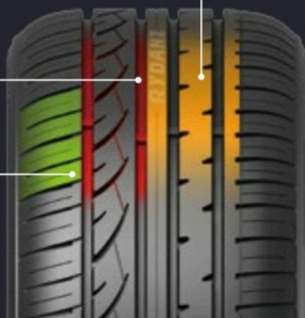
El diseño de bloque de patrón de inverso de varios pasos proporciona un excelente entorno de conducción silenciosa, y la nervadura central garantiza la estabilidad de la conducción recta a alta velocidad.
